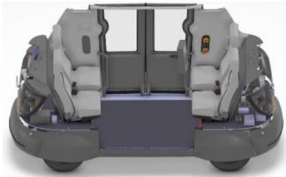
Figur 1. Cutaway of LSAV seating arrangement. Återanvänd med tillstånd från Elsevier (Paddeu et al., 2020, s. 120)
